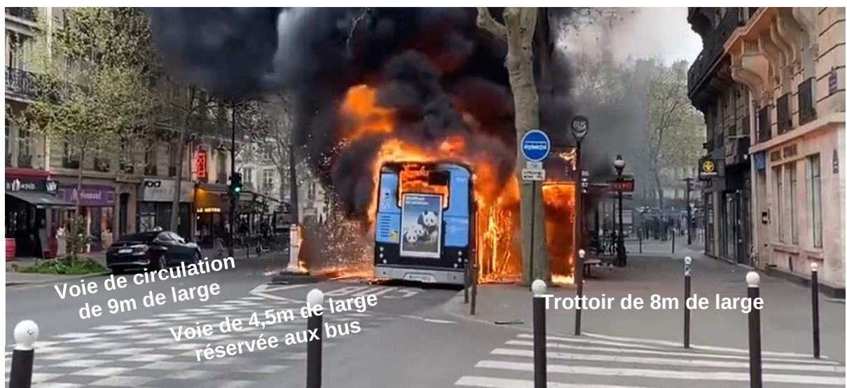
Figure 8 : Incendie généralisé et projections de métal en fusion Source : Capture d'écran Twitter / @JPFOTOGRAFOSS légendée BEA-TT
