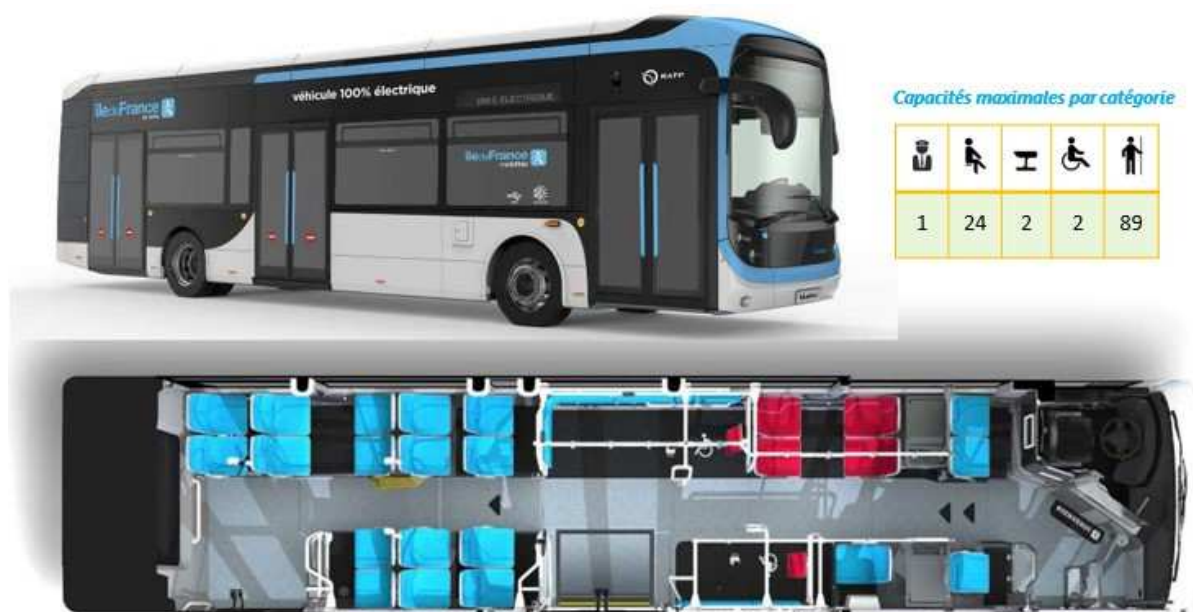
Figure 3 : Vue extérieure et aménagements d'un bus 12 m - IT3 Photo Bluebus
