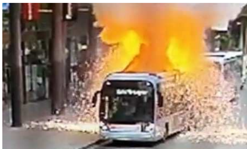
Figure 16 : Explosion des batteries Source : Témoins BFMTV
